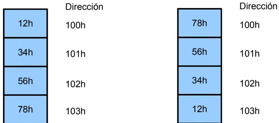
Figura 5: Ejemplo de los dos tipos de orden para datos multibyte.
